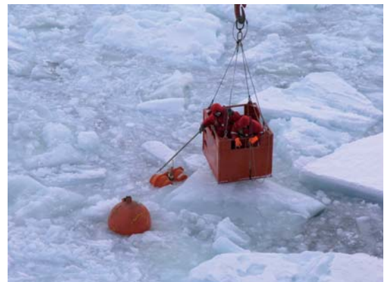
Ein verankertes Messsystem wird vom Meereis aufgenommen. Quelle: www.awi.de
